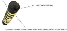
LONGITUDINAL SEWING FOR REDUCING THE PRESSURE DROP
